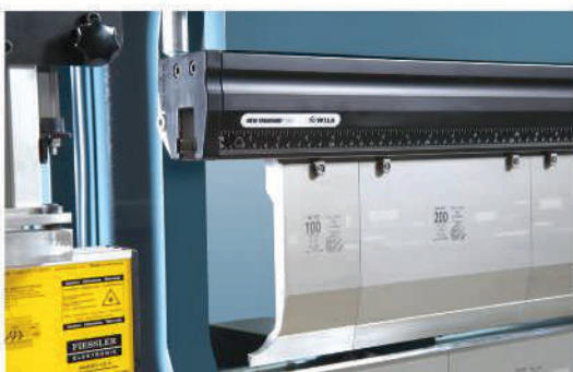
Крепление верхнего инструмента Wila
