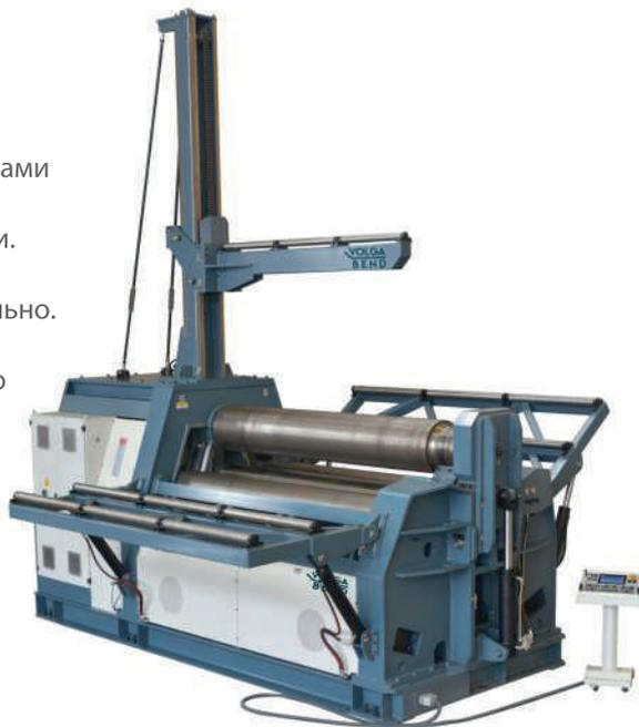
поддержки, боковая опорная система с двойным поворотным суппортом может обеспечить точные и совершенные изгибы. Данные суппорты могут быть созданы в соответствии с запросом клиентов.
